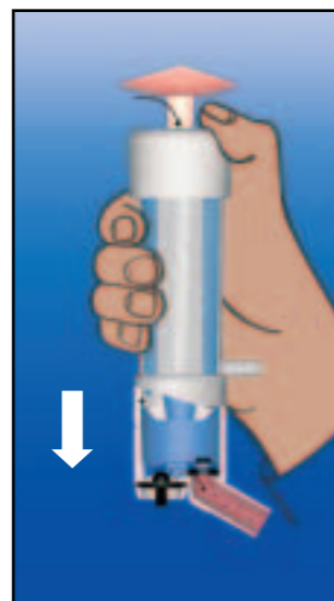
La retirada manual se efectúa colocando un dedo entre el pezón y el caucho de la pezonera. De esta manera, el aire atmosférico entra en la pezonera, lo que compensa el vacío, y ahora se puede retirarla. Al mismo tiempo, el vacío de ordeño se cierra automáticamente.
